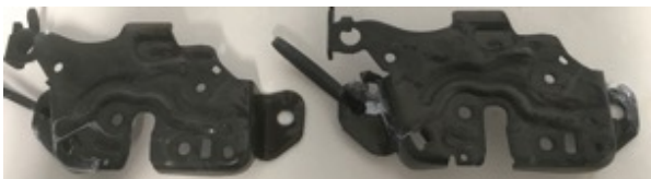
Obr. 5 Stav dílců z linky alkalický Zn, pasivace UltraPas Zn 130 A2 (GA Profi Trex), UltraSeal PD po rozdílné zátěži testu NSST
