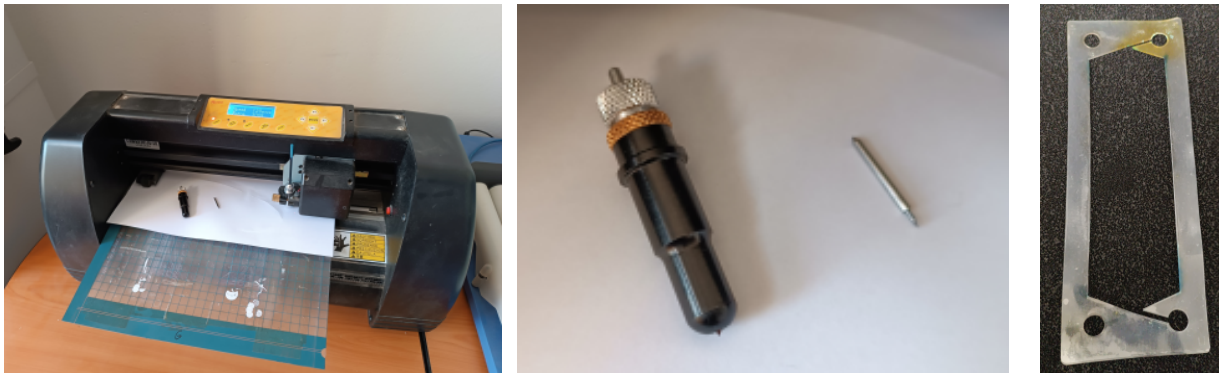
Obrázek 2: Vyřezávací plotr, řezací nože a těsnění z PVC vyříznuté pomocí plotru.
