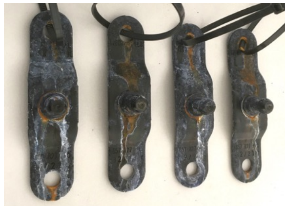
Obr. 2 Stav černého konverzního povlaku na ZnNi s aplikací anorganického Cr(III) post dipu po dvaceti cyklech PV 1210
