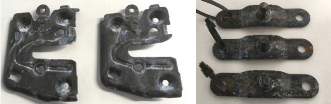
Obr. 1 Stav černého konverzního povlaku na ZnNi s aplikovaným organickým utěsněním na bázi polyuretanu (vlevo) a polyakrylátu (vpravo) po dvou cyklech PV 1209
