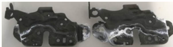
Obr. 5 Stav dílců z linky alkalický Zn, pasivace UltraPas Zn 130 A2 (GA Profi Trex), UltraSeal PD po rozdílné zátěži testu NSST
