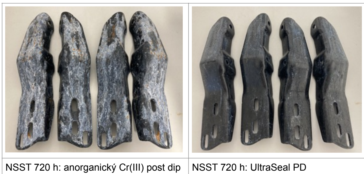
Obr. 4 Srovnání výsledků cyklického testu NSST po 720 h na dílcích z produkce ZnNi lišících se pouze finální povrchovou úpravou Cr(III) post dip (vlevo) a UltraSeal PD (vpravo)
