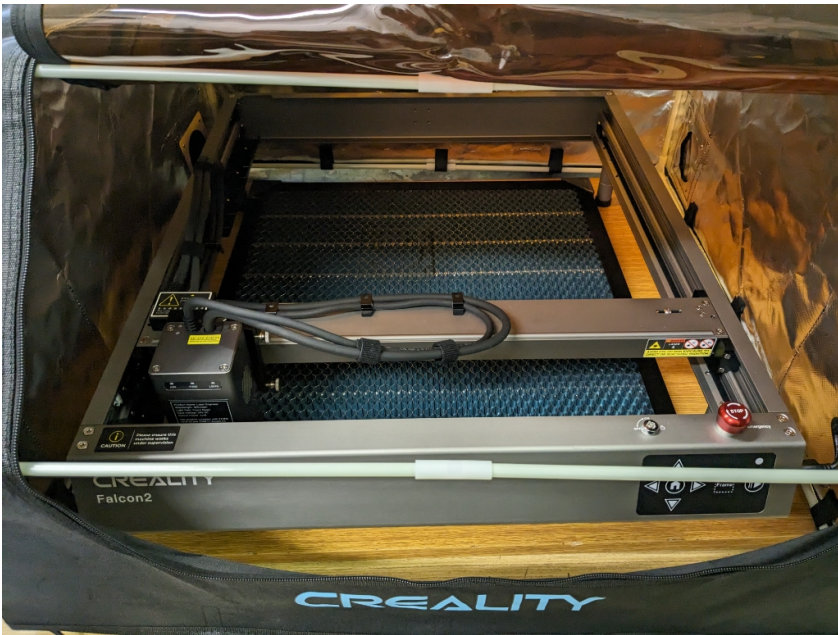
Obrázek 3: Laserový CNC gravírovací stroj s výkonem laseru 22 W s odtahem zplodin.
