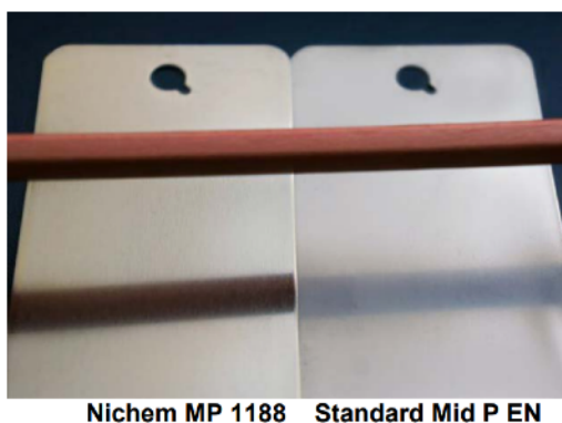
Obrázek 3 Porovnání lesku Nichem® MP 1188 a standardního středofosforu při kontaminaci zinkem 130 mg/l.
