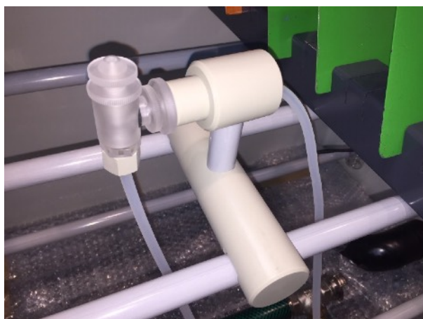
Obr. 7: tryska s variabilním umístěním
