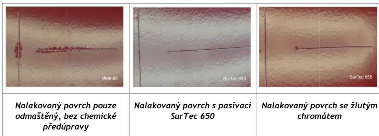
Obrázky 5–7: Srovnání odolnosti vůči tzv. filliform korozi pasivace SurTec 650 s chromátem a povrchu bez chemické předúpravy
