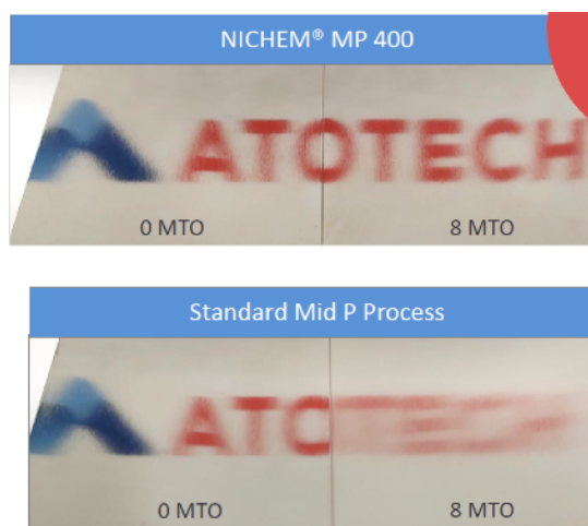
Obrázek 6 Porovnání lesku standardního středofosforového niklu s Nichem® MP 400.
