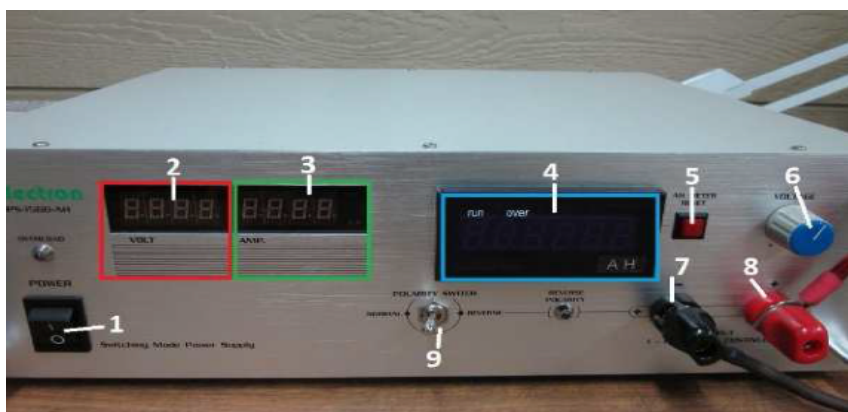
Obr. 3 Zdroj stejnosměrného proudu
