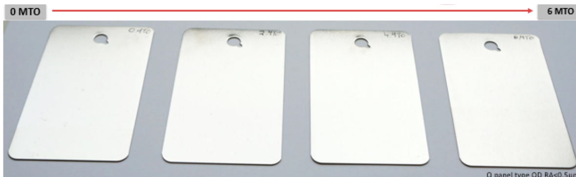
Obrázek 7 Korozní odolnost Nichem® HP 1170 v testu s kys. dusičnou (65 %, 30 s, 10 \mu\text{m} EN).
