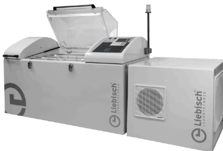
Obr. 9: komora s kompresorovou chladicí jednotkou C – umístěna vpravo
