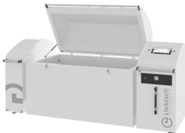
Obr. 5: truhlová komora dodávaná ve 3 částech (při zprovoznění se pevně propojí) vlevo- nádrž na solanku, uprostřed - pracovní prostor, vpravo- strojovna
