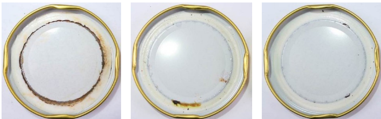
Obrázek 5: Příklady korozního napadení uzávěrů – vzorky 2
