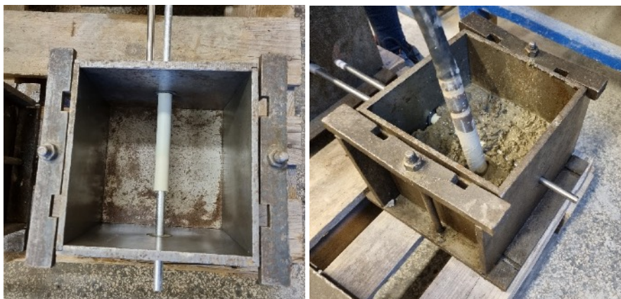
Obr. 1 Detail přípravy forem pro zkoušku soudržnosti pull-out test dle RILEM RC 6.
