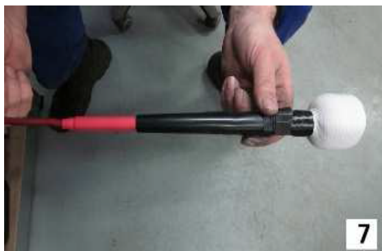
Obr. 4 Tampon pro funkčně technické pokovení
