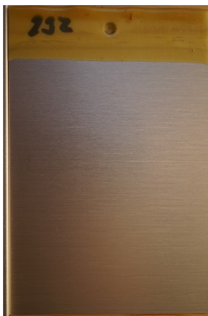
Obrázek 5: Vzorek po 504 h v NSS dle ASTM B 117
