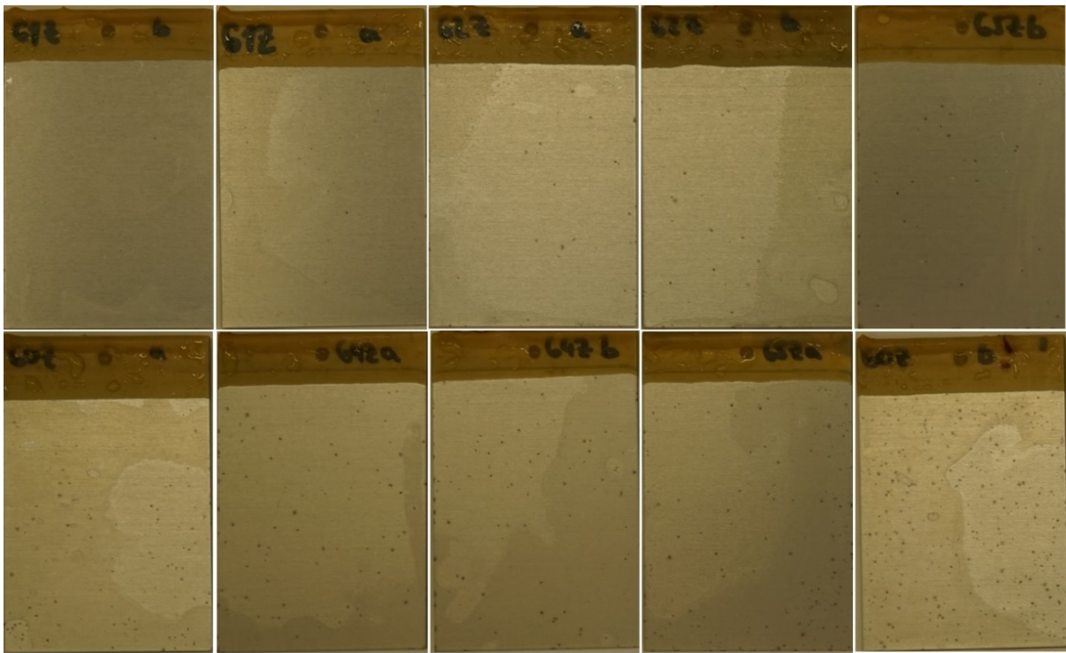
Obrázek 7: Vzorky TSAA s komerčním aditivem na organické bázi (Lázeň 3) po 24 h v Machu testu
