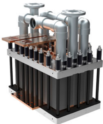
Obrázek 4: Elektrolyzér s protonově vodivou membránou společnosti Hydrogenics o výkonu 1,5 MW a kapacitě 285 Nm 3 H 2 /h.
