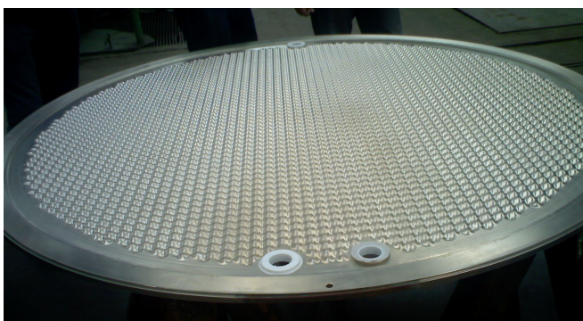
Obrázek 3: Bipolární rozvodná deska v alkalickém elektrolyzérovi vody
