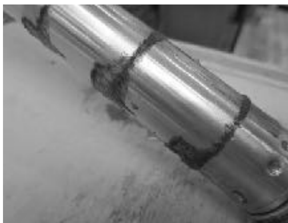
Obr. 2 Zachycené částice na neodymovém magnetu
