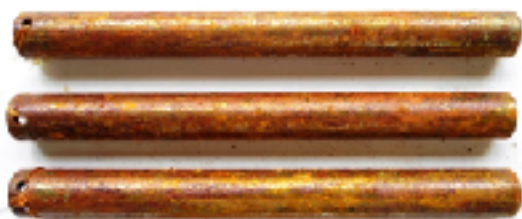
Obrázek 10. Vzhled vzorků po expozici - sada 3.
