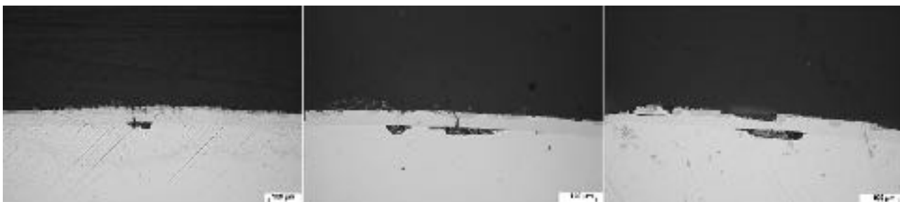
Obrázek 13. Metalografické výbrusy vzorků po expozici v prostředí SO 2 postupně po 2, 3 a 4 cyklech - sada 3.
