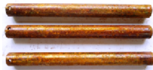
Obrázek 11. Vzhled vzorků po expozici - sada 4.
