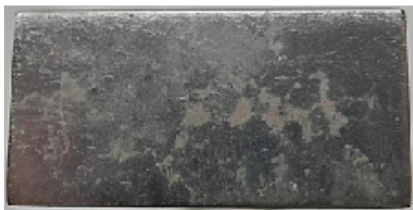
barevné skvrny na povlaku stříbra
