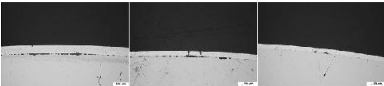
Obrázek 12. Metalografické výbrusy vzorků po expozici v prostředí SO 2 postupně po 2, 3 a 4 cyklech - sada 1.
