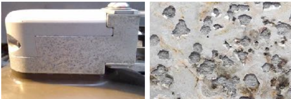
Obrázek 5: Podkorodování povlaku stříbra na hliníkovém materiálu
