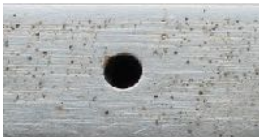
korozní důlky v povlaku stříbra
