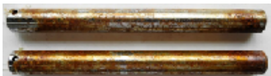
Obrázek 8. Vzhled vzorků po expozici - sada 1.
