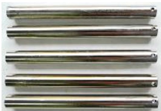
Obrázek 4. Vzhled vzorků před expozicemi - sada 3.
