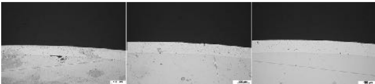
Obrázek 13. Metalografické výbrusy vzorků po expozici v prostředí SO 2 postupně po 2, 3 a 4 cyklech - sada 2.
