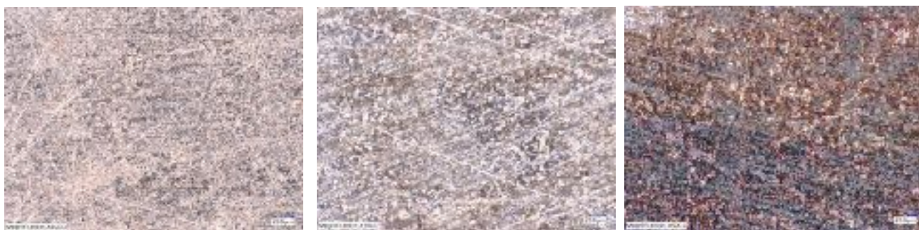
Obrázek 9: Vzorky stříbra před (a) a po expozici v kondenzačním (b) a v TAA testu (c) detaily 500x zvětšeno
