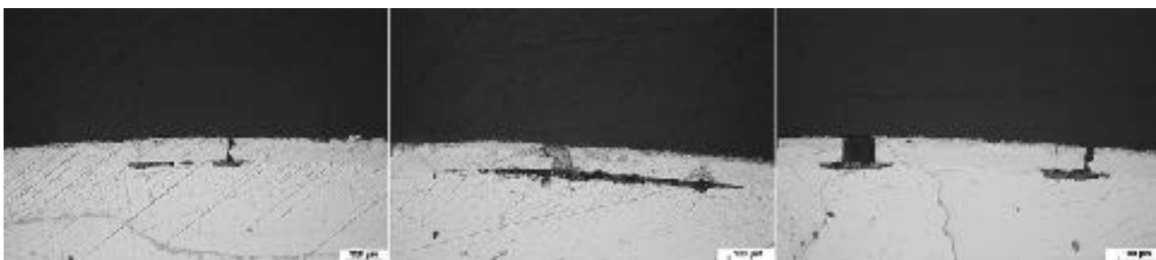
Obrázek 14. Metalografické výbrusy vzorků po expozici v prostředí SO 2 postupně po 2, 3 a 4 cyklech - sada 4.
