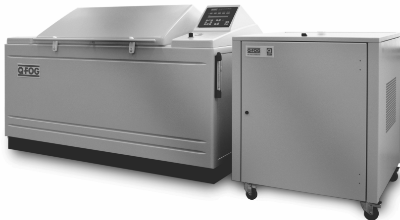
Obr. 1: Cyklická korozní komora Q-FOG CRH 1100 s regulací relativní vlhkosti a rampovými funkcemi změny podmínek, vpravo je přes vzduchovou hadici (vzadu) připojen pre Kondicioner
