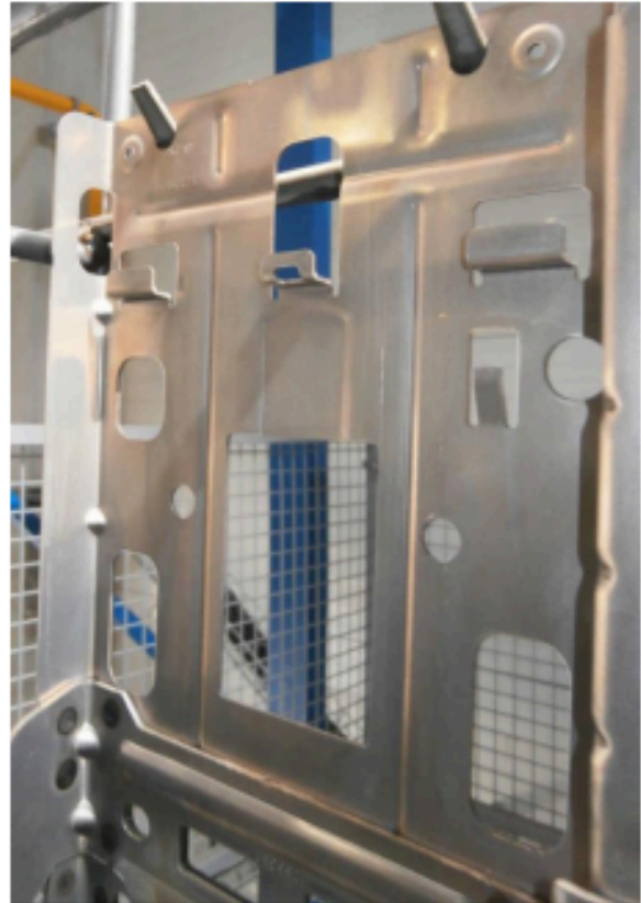
Obr.6: Typicky zlatavá barva konverzní pasivace povlaku SurTec 609 EC, z provozu v ČR.
