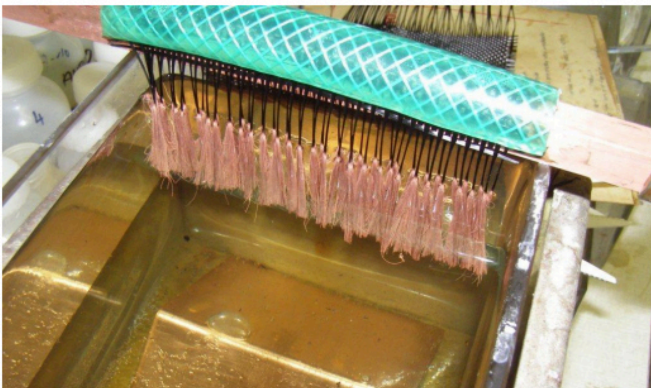
Obr.3. Pokovování pramců v kyanidové mědicí lázni
