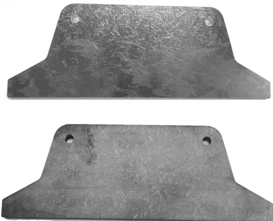
Obrázek 4: Díl se zinkovým povlakem a po jeho sejmutí
