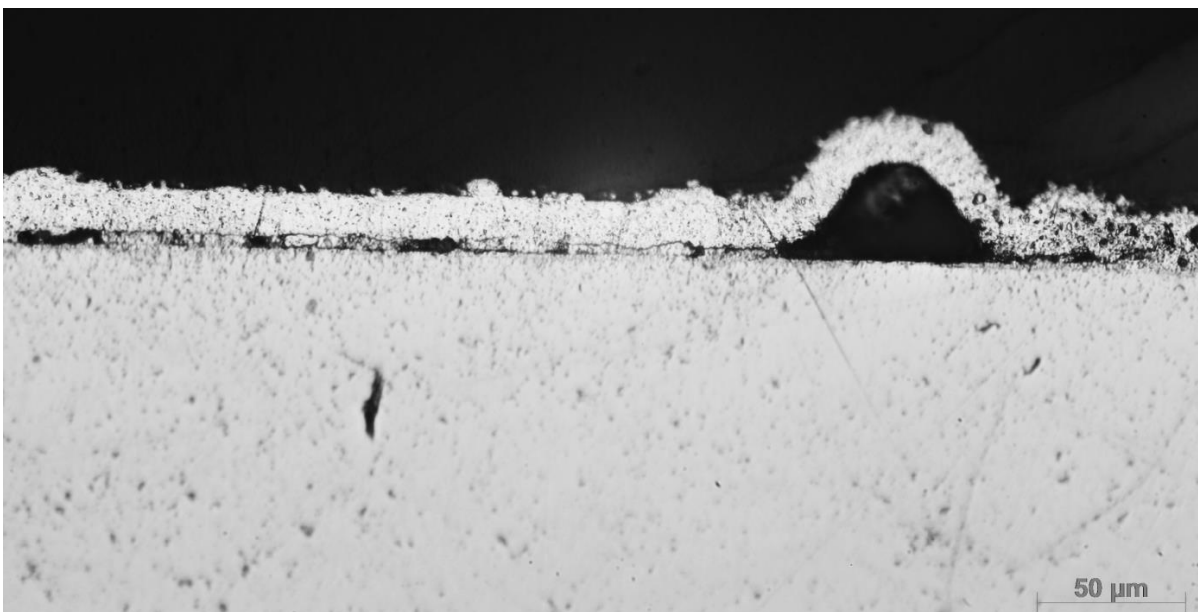
Obrázek 8: Příklady metalografických výbrusů zinkového povlaku (500x zvětšení)
