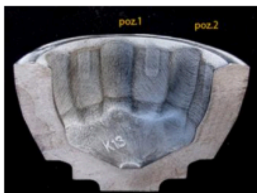
Obr. 14 Vnitřní část výkovku po moření
