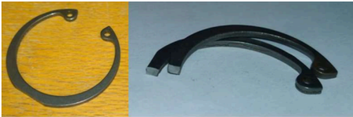
Obrázek 2 Zkušební vzorky před a po zkoušení na pulsátoru cyklického namáhání PCN1
