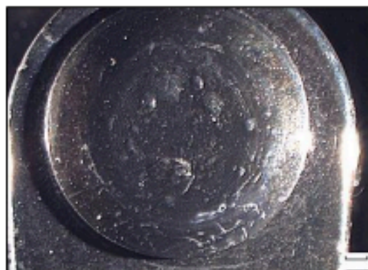
Obr. 2 Puchýře a ztráta přilnavosti povlaku
