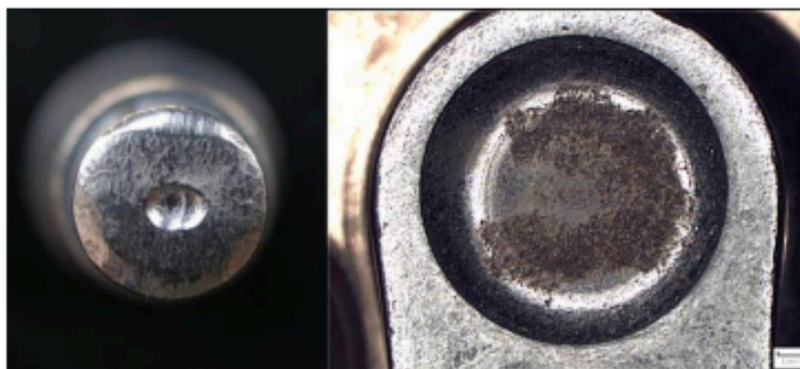
Obr. 5 Vlevo: Čelo čepu – středící důlek, vpravo: nýtovaný povrch, přeložky, Fe korozie
