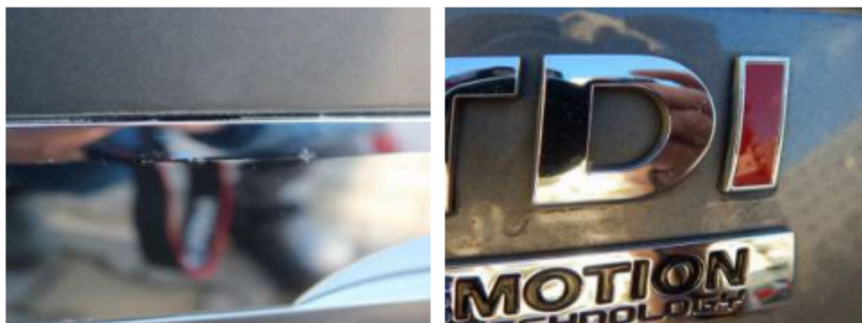
Obrázek 5 – Příklady poškození povrchové úpravy plastových dílů
