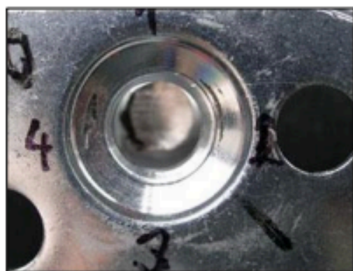
Obr. 6 Deska nájezdu – vada Zn povlaku
