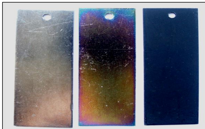
Obr. 1 Makroskopická dokumentace povrchu, zleva: první dva povlaky vykazují známky mechanického poškození, na povrchu třetího vzorku byly identifikovány puchýře
