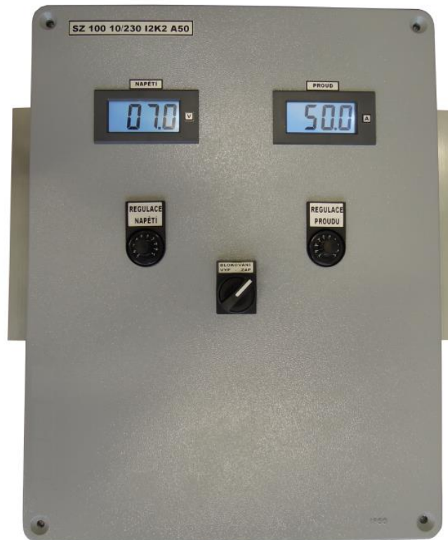
Obr.5 Příklad konstrukce zdroje se synchronním usměřovačem
