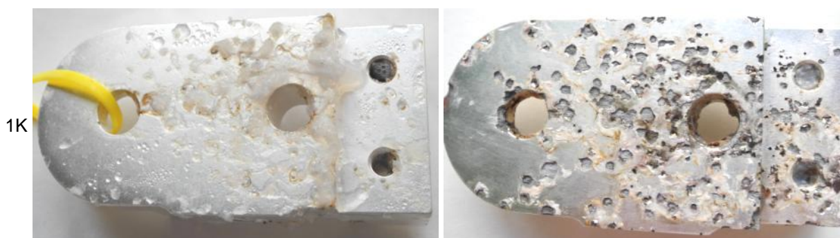
Obrázek 10 – Korozní poškození vzorků s kombinovanými chemickými a elektrolytickými povlaky niklu s elektrolytickým povlakem stříbra po 24 (pro vzorek 1K), resp. 72 a 240 h expozice ve zkoušce NSS
