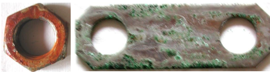
Obrázek 7 – Vzhled vzorků s povlakem niklu po 48 h AASS zkoušky na podkladových materiálech uhlíková ocel a měď
