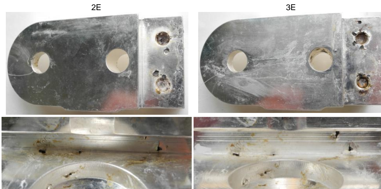
Obrázek 9 – Korozní poškození vzorků s povlakem elektrolytického niklu a elektrolytického stříbra po 240 h expozice v zkoušce NSS
