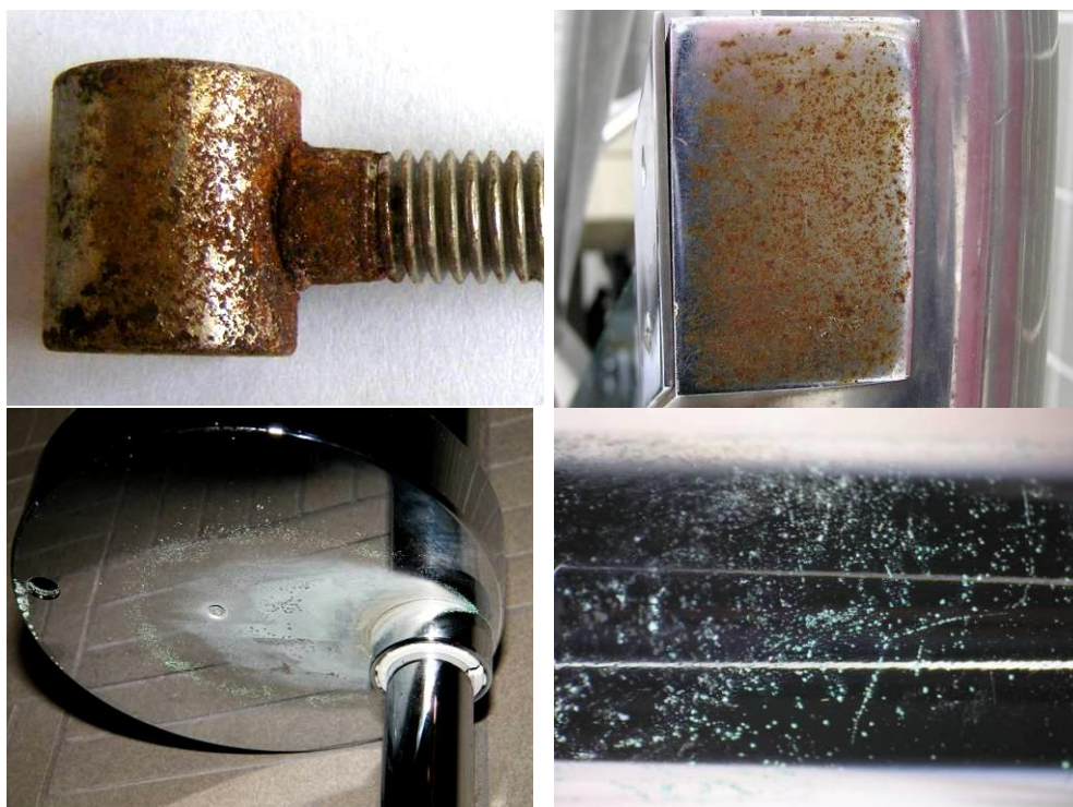
Obrázek 6 – Příklady korozního chování niklového povlaku na oceli a na mezivrstvě mědi
