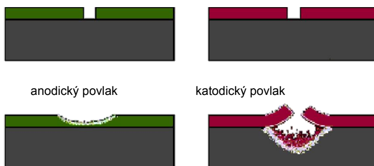
Obrázek 5 – Korozní mechanismus anodických a katodických povlaků
