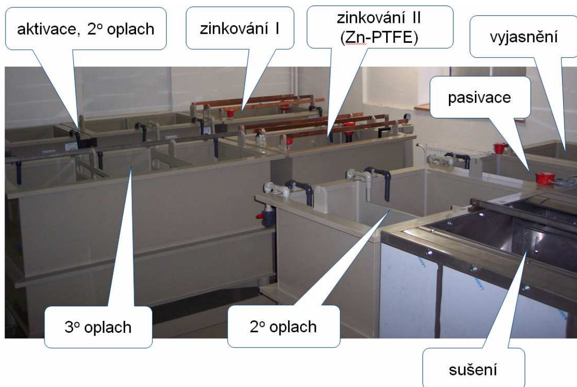
Obrázek č. 1: galvanická linka pro vylučování kompozitního povlaku Zn-PTFE
