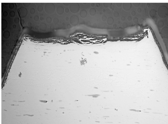
Obrázek 8 – Metalografický výbrus zinkového povlaku na závitové vložce B (zalisované), 250x zvětšení
