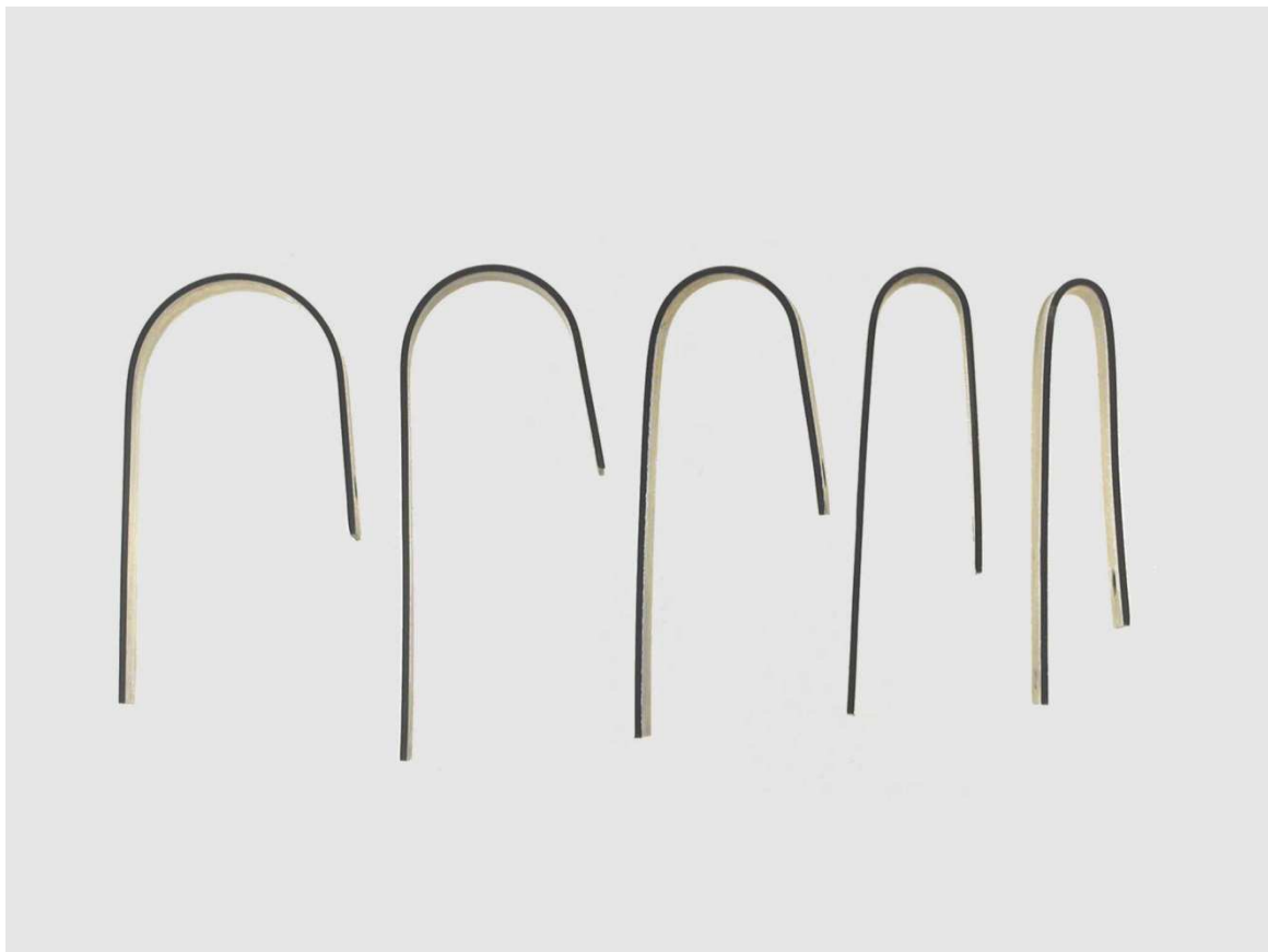
Obr. 2 Zkušební tělesa po ohybech (měření tvárnosti Zn povlaků)
