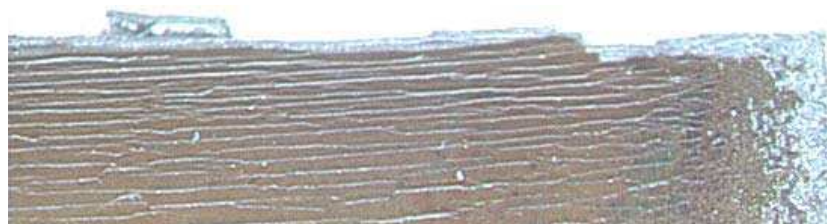
Obrázek 2 – Povlak ZnNi po ohybové zkoušce přilnavosti - výskyt prasklin, ale povlak se neodlupoval
