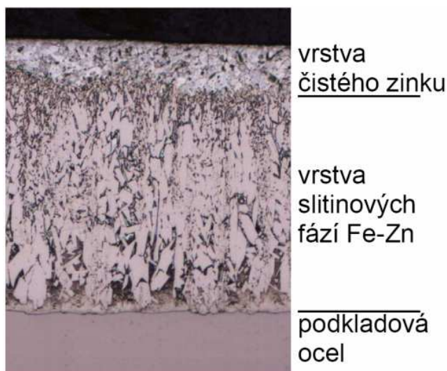
Obr. 2 Povlak na oceli uklidněné křemíkem
