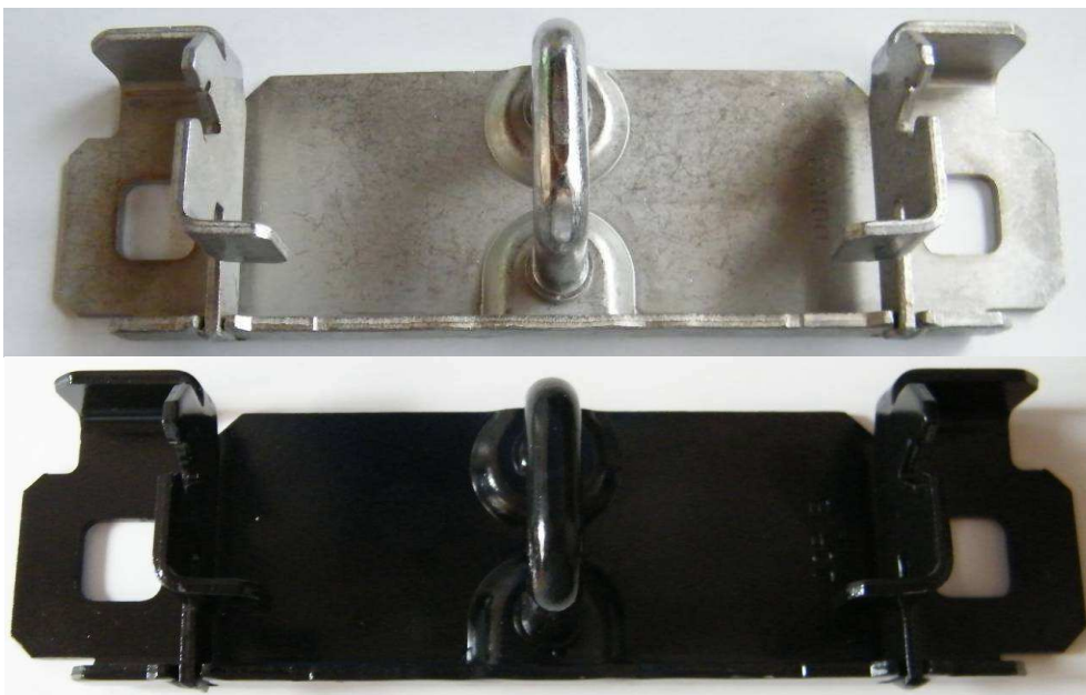
Obrázek 5 – Součástka se slitinovým Zn-Ni povlakem (a) a následně kateforeticky naneseným nátěrem (b)
