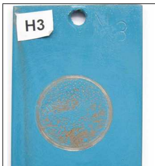
Obr. 6 Vizuální charakterizace typického kohezního lomu
