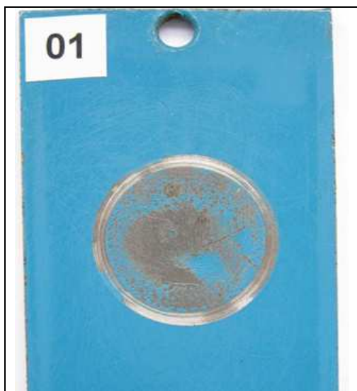
Obr. 5 Vizuální charakterizace typického adhezního lomu
