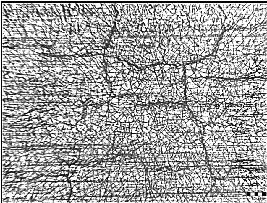
Obr. č. 4 Mikroskopická dokumentace mikrotrhlinkového povlaku Cr, stopy po broušení povrchu. (M 200:1)
