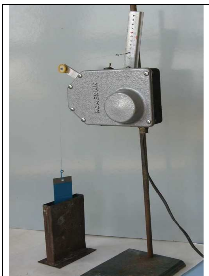
Obr 3. Zařízení s volnou kladkou pro vytvoření rovnoměrného povlaku organického emailu S2053.
