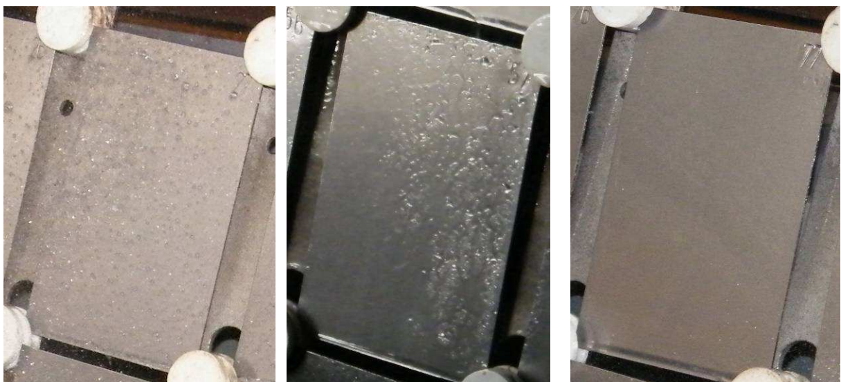
Obrázek 2 – Postupné odstranění zamaštění
