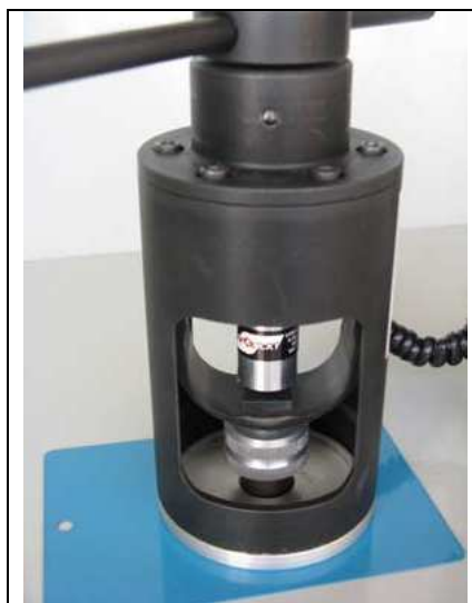
Obr 4. Odtrhové zařízení Comtest OP 1/0 s upevněným vzorkem.
