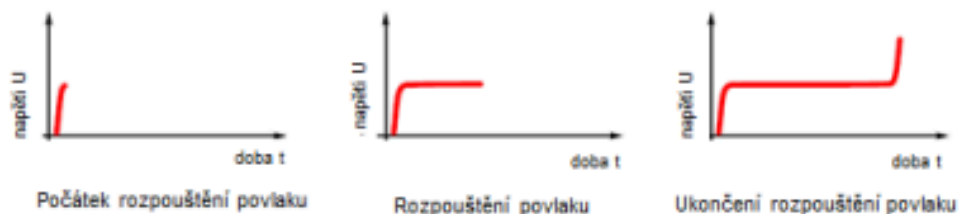
Obrázek 3 – Průběh potenciálu při měření (rozpouštění povlaku)
